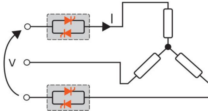
Câblage triangle avec charge résistive (commande sur deux phases)
