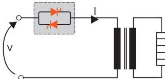
Câblage en triangle ouvert avec charge résistive
