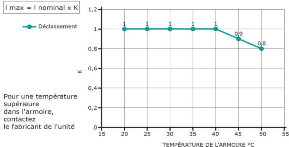
Fonctionnement à des températures de fonctionnement supérieures à 40°C non couvertes par UL®
