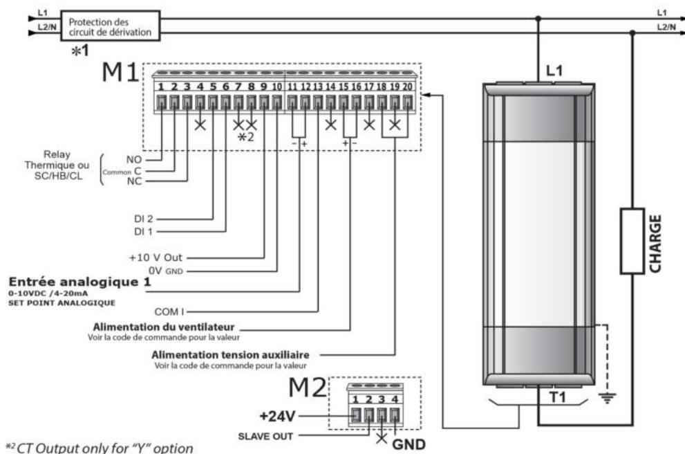
**Remarque:** la tension Aux et la tension de charge doivent être synchronisées.
