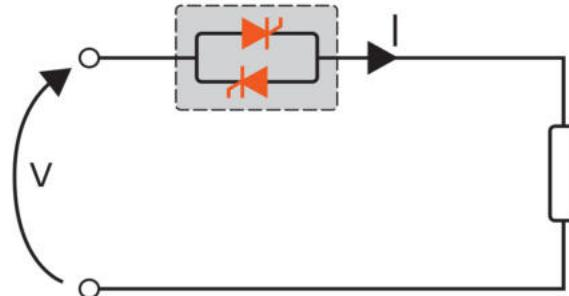
Câblage en triangle ouvert avec charge résistive
