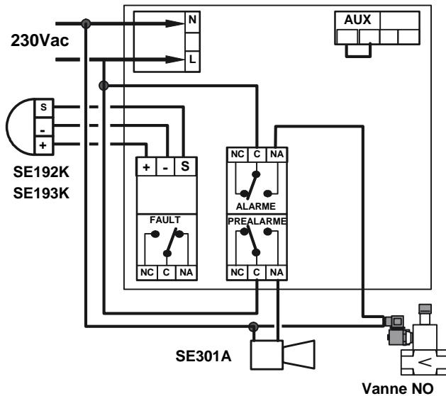
**Exemple de raccordement au réseau 230 Vac avec sirène, électrovanne normalement fermée à réarmement manuel et capteur de position (modèles VR420 ... VR480)**
