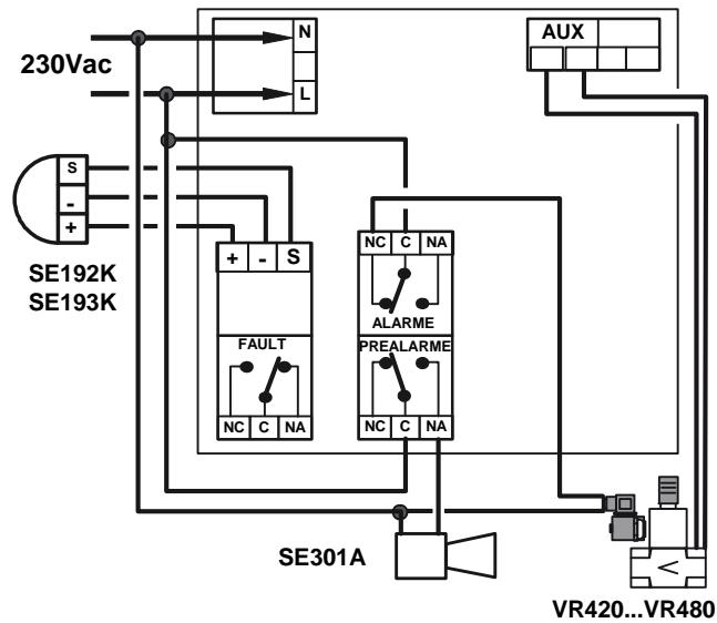
**Exemple de raccordement avec sirène et électrovanne normalement fermée à réarmement manuel alimentée en 12 Vdc** (avec, par exemple, le bloc d'alimentation 12 Vdc PS180 avec batterie interne 7Ah pour maintenir le système sous tension en l'absence d'alimentation électrique principale)
