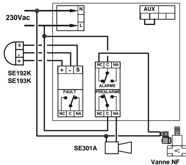
**Exemple de raccordement au réseau 230 Vac avec sirène et électrovanne normalement ouverte à réarmement manuel**
