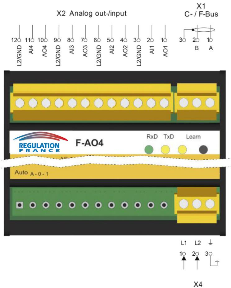
>> Exemples de raccordements électriques
