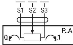
Recommandation : raccordement comme diviseur de tension
